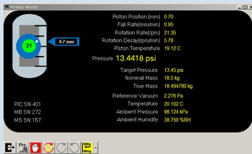
Visuelle Echtzeitüberwachung von Kolbenmanometer-Parametern mithilfe von kompatiblen Geräten ist in COMPASS möglich. Sogar mit ready/not ready Anzeige.
